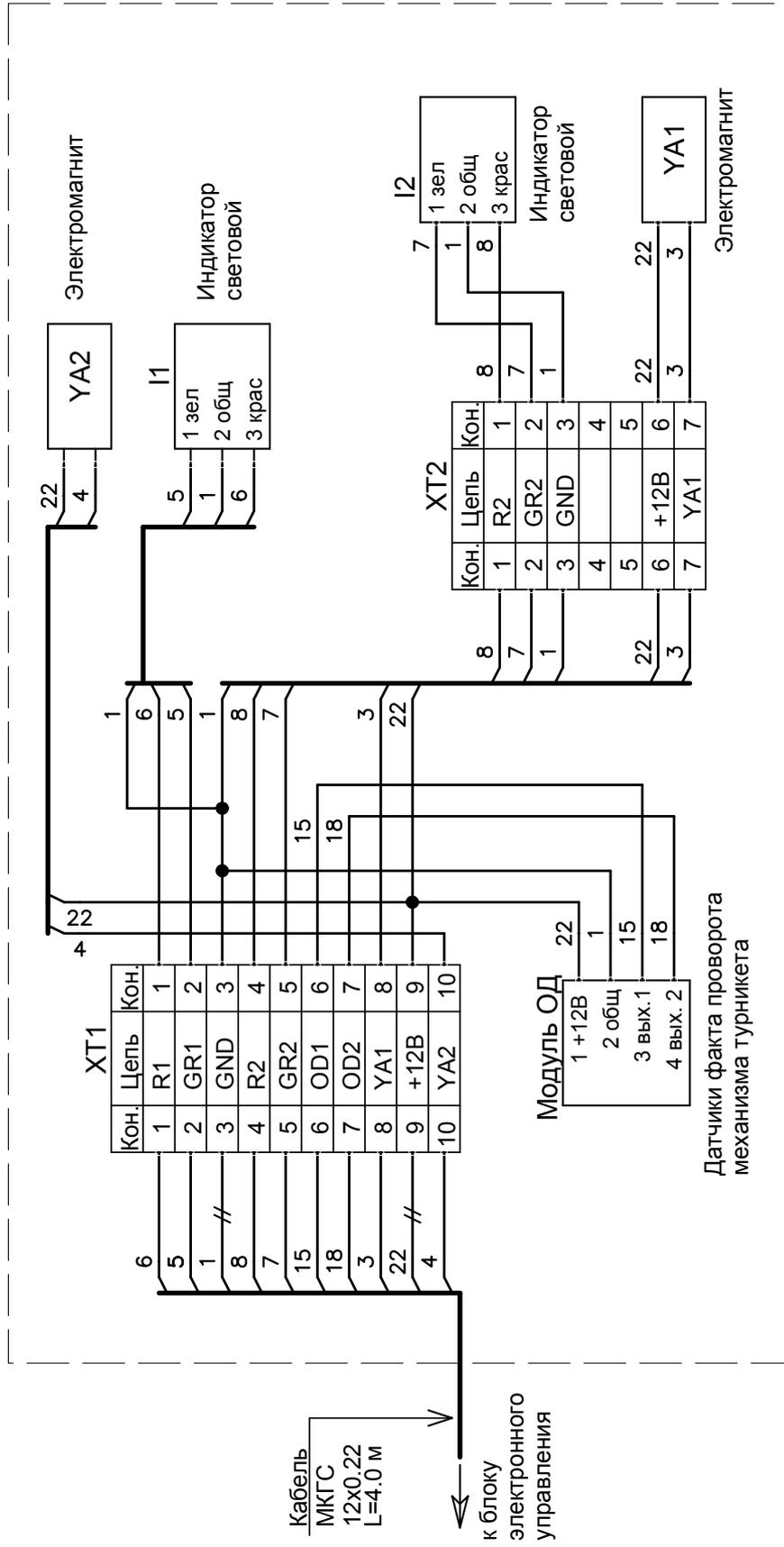
Схема электрическая принципиальная турникетов "Ростов-Дон Т2М, Т72, Т83, ..." половина схемы Т283" уличного ИСПОЛНЕНИЯ со счётчиком
