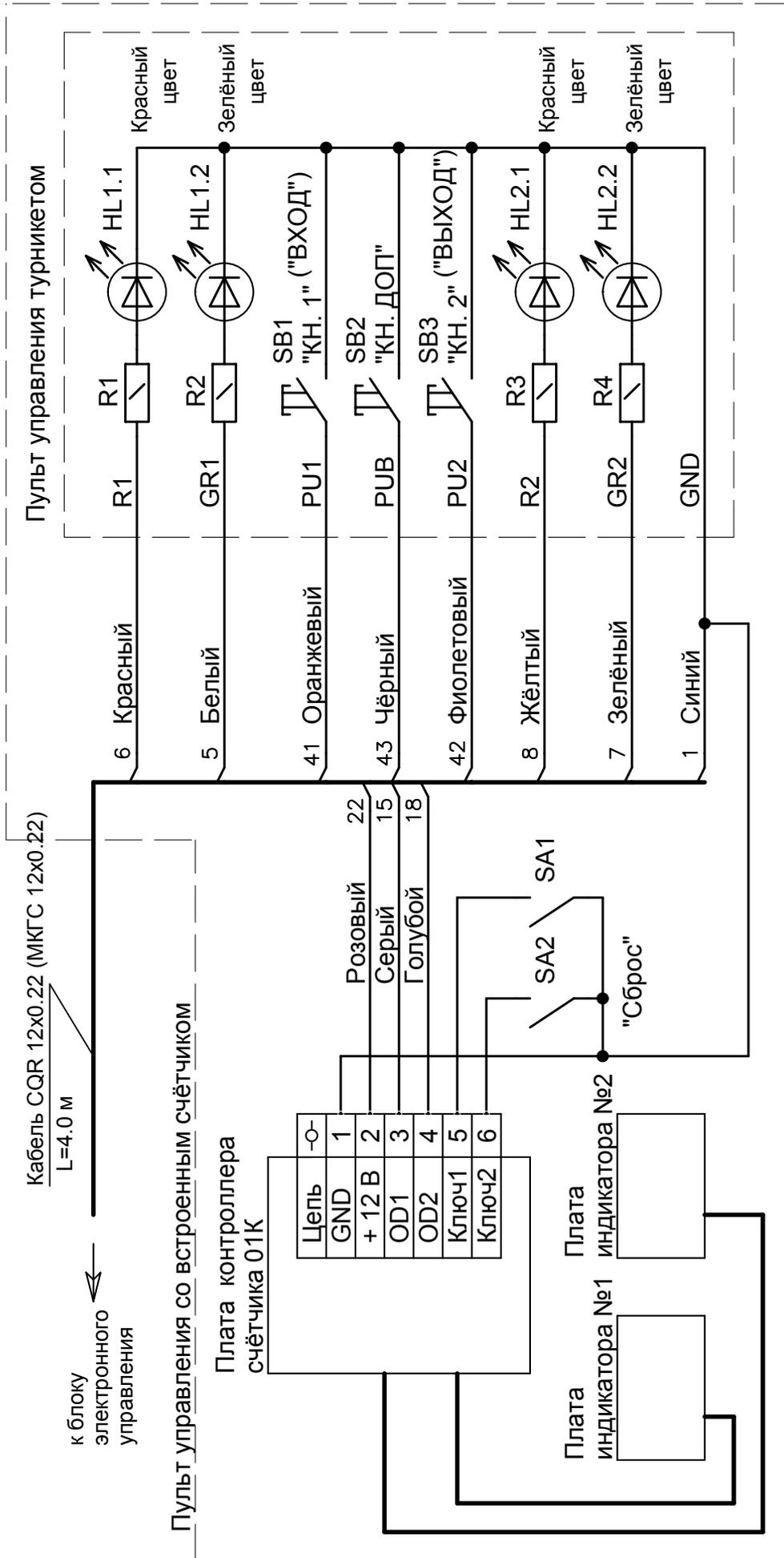
Примечание 1. Для использования счётчика не с турникетными датчиками, а в режиме независимого подсчёта по цепям "OD1" и "OD2", необходимо напаять перемычку на плате от конт. 23 контроллера PIC16F870 на конт. 1 клеммника ХТ1. Счёт будет производиться по замыканию цепей "OD1" и "OD2" на общий провод независимо друг от друга. Ток потребления по каждой цепи - не более 12 мА. Можно использовать контакты реле, герконы и т. д.
