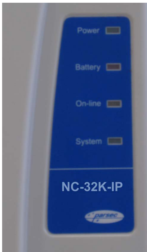
Рисунок 23. Внешняя индикация состояний контроллера.
