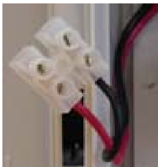
Рисунок 12. Кабель для подключения замка к источнику питания.
