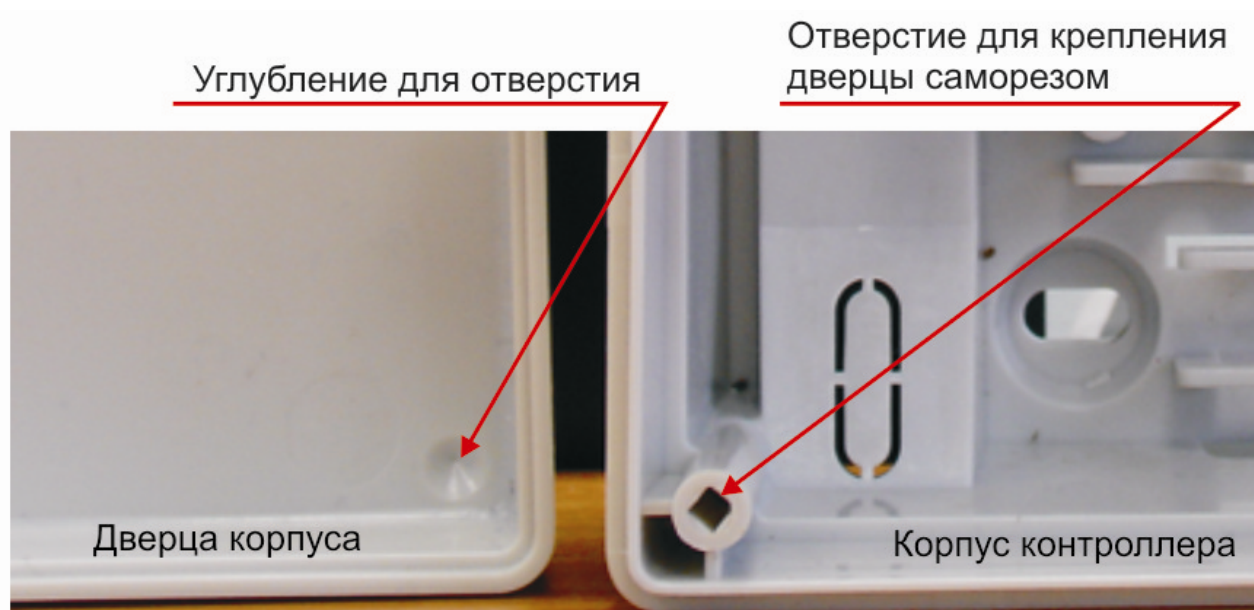
Рисунок 3. Схема «жесткого» крепления дверцы к корпусу контроллера.
