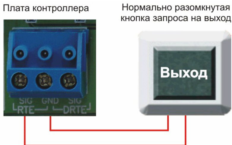
Рисунок 9. Схема подключения кнопки запроса на выход.
