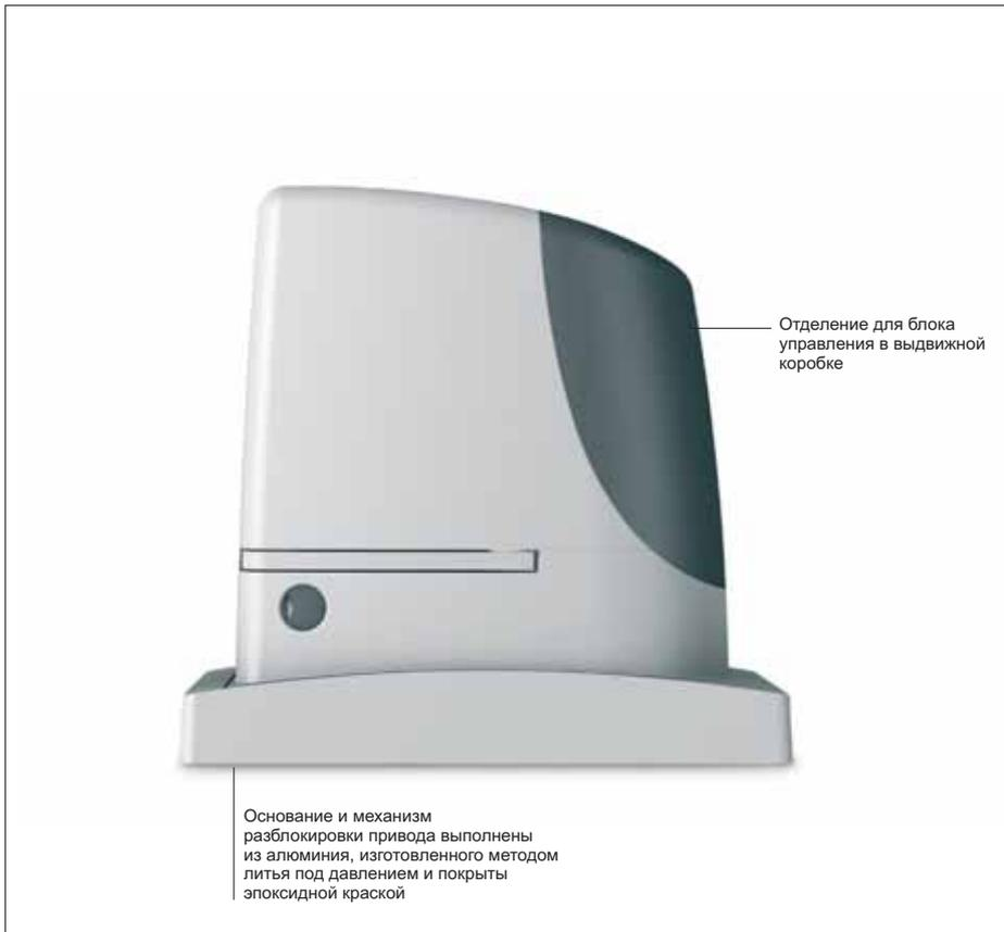
**Электромеханические приводы для автоматизации откатных ворот весом до 1800 кг (RUN1800) и 2500 кг (RUN2500). Двигатель с самовентиляцией с индуктивным концевым выключателем (RUN1800P/RUN2500P) и с электромеханическим концевым выключателем (RUN1800/RUN2500/RUN2500I).**
